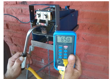
使用超高温度计来测量刀片温度，需达到650°C左右
